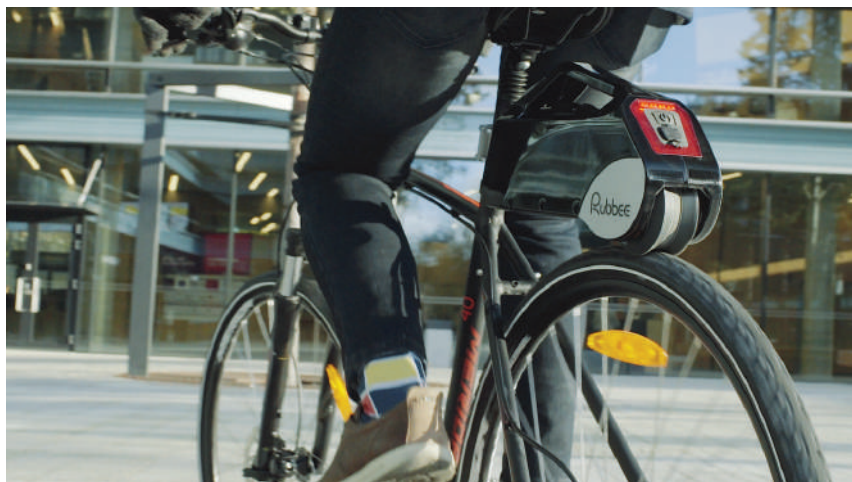
2.1 pav. Pavara „Rubbee“, paprastą dviratį paverčianti elektriniu
