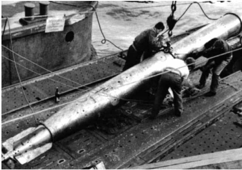
Vyksta torpedų iškėlimo ir nuleidimo į povandeninį laivą per specialų liuką darbai.
