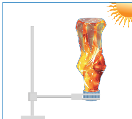
2.3.1 pav. Metano chlorinimo bandymas dėl sprogsmo atliekamas plastikiniame inde.
